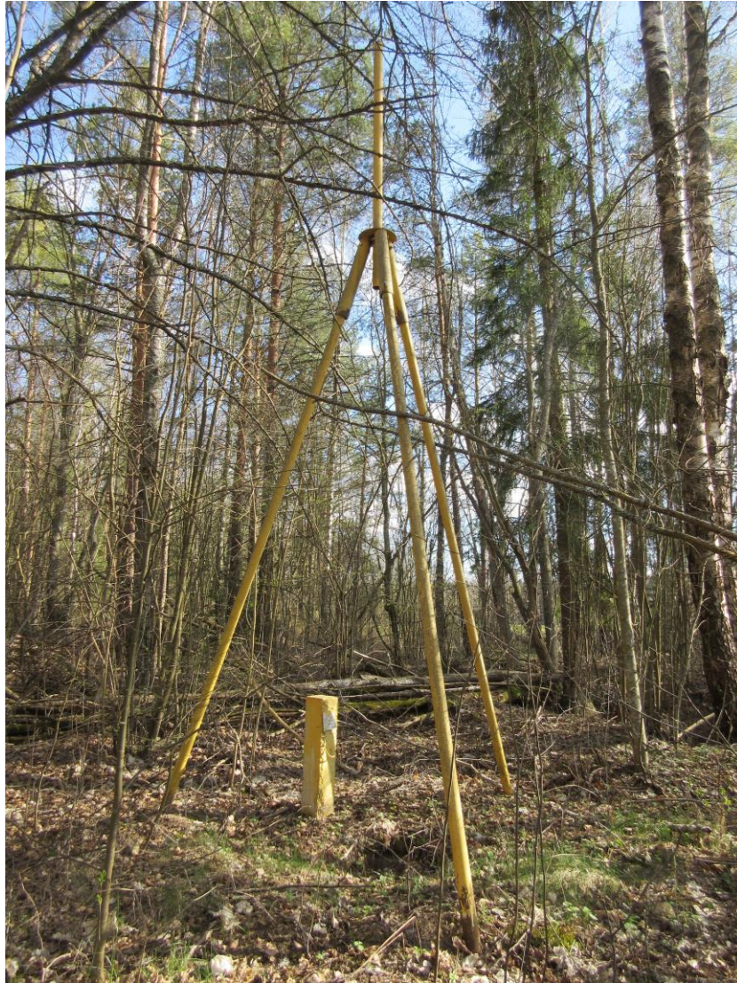
Металлическая геодезическая пирамида и опознавательный столбик на тригонометрическом геодезическом пункте 168.3 м, расположенном на западной окраине деревни Жуковец. Вокруг него следы старых немецких оборонительных окопов времен ВОВ
